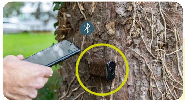
Con el PYRO Nano la recolección de datos es inalámbrica vía Bluetooth usando un dispositivo móvil. Entonces, una vez recolectados con la app Eco-Link Evo, los datos son visibles en Eco-Visión, tu tablero de análisis de datos online.
