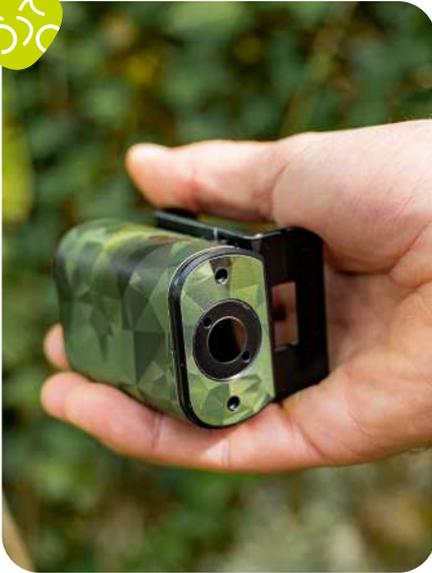
El PYRO Nano es un todo en uno, contador de personas ligero y compacto. El sistema combina un lente de alta precisión con tecnología piroeléctrica infraroja pasiva para detectar el calor emitido por el cuerpo humano. Resistente al agua y discreto, puede contar usuarios hasta a una distancia de 4 metros (13 pies) y detectar dirección. Fácil de instalar en la mayoría de las superficies como un tronco, poste o una rama.
